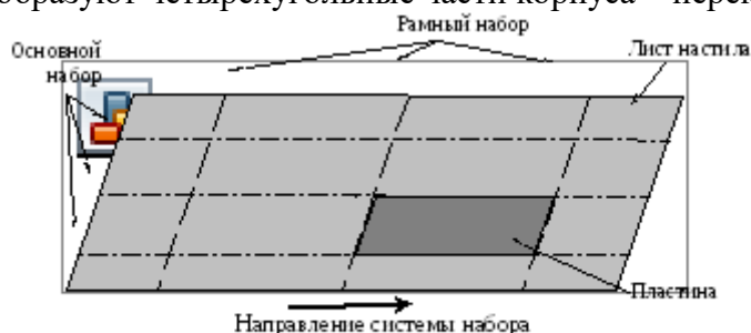
Рис. 2.1. Пластины и система набора
